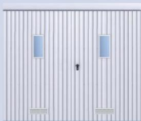
La porte suspendue coulissante à deux ouvrants, remplie de la tôle T-10, l'orientation de remplissage vertical, la porte avec des hublots horizontaux et une grille de ventilation
